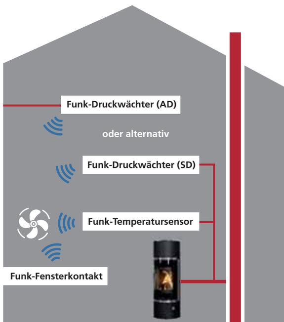
Einfachbelegung: An einem Schornstein wird ein Kamin- oder ein Pelletofen betrieben.
