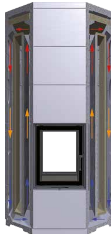
Temperaturverlauf bei insgesamt 2 x 4,2 kg Holzauflagemenge
